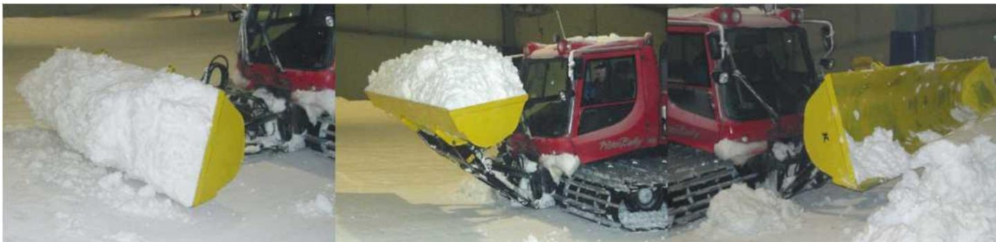
Прекрасное дополнительное оборудование для транспортировки снега на короткие и средние дистанции по склону, подъемнику или автостоянке, а также для заполнения образовавшихся ям или расчистки.
